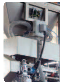
Dosatore pendolare doppio • Twin pendular doser Doble dosificador pendular
